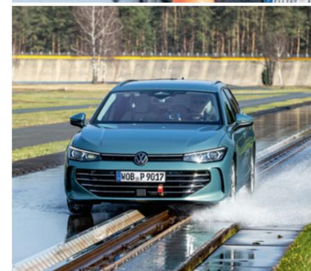
Aquaplaning: Die Räder einer Seite fahren durch tiefes Wasser – wie in einer Pfütze. Je besser die Drainage-Wirkung, desto später schwimmt der VW auf.
