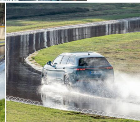
Nasshandling: Stille Wasser sind rutschig! Auf der konstant beregneten Prüfstrecke ermitteln wir exakt, wie hoch die Haftgrenze jedes einzelnen Reifentyps liegt.
