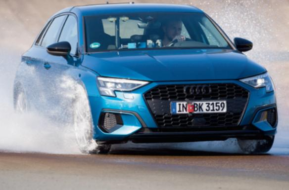
**Außengeräusche: Auf einer normierten Versuchsbahn wird das Vorbeifahrtgeräusch gemessen.**
