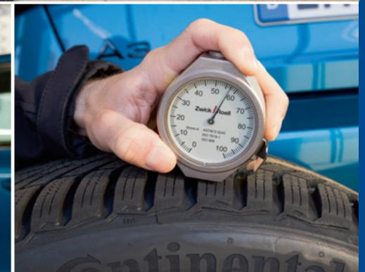
**Härtegrad: Eine Shore-Härte von unter 60 zeichnet eine kälteelastische Gummi-Mischung aus.**
