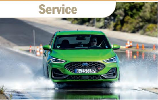
**Aquaplaning, längs:** Über Drehzahlunterschiede an Vorder- und Hinterachse prüfen wir exakt, ab wann die Profile jeweils den Bodenkontakt verlieren.
