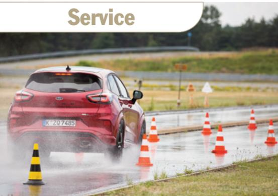
Die Laufflächenmischung ist entscheidend dafür, wie gut ein Profil beim Bremsen auf nassem Asphalt haftet – hier bei der Vollverzögerung aus 100 km/h auf 0,6 mm hohem Wasser.
