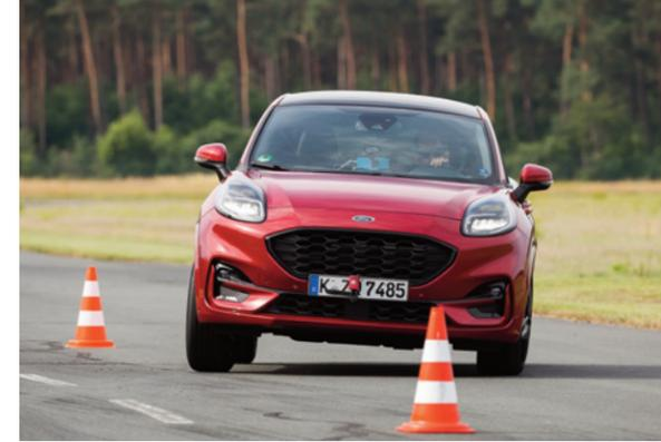
Bereits eine verunreinigte Fahrbahn kann die Messung des Vorbeifahrgeräuschs beeinflussen, die bei 80 km/h mit abgeschaltetem Motor durchgeführt wird.
