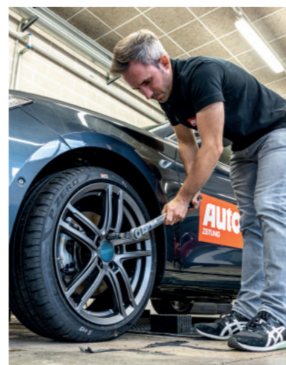
Beim Testen ist Präzision gefragt, da muss auch das Anzugsdrehmoment stimmen.
